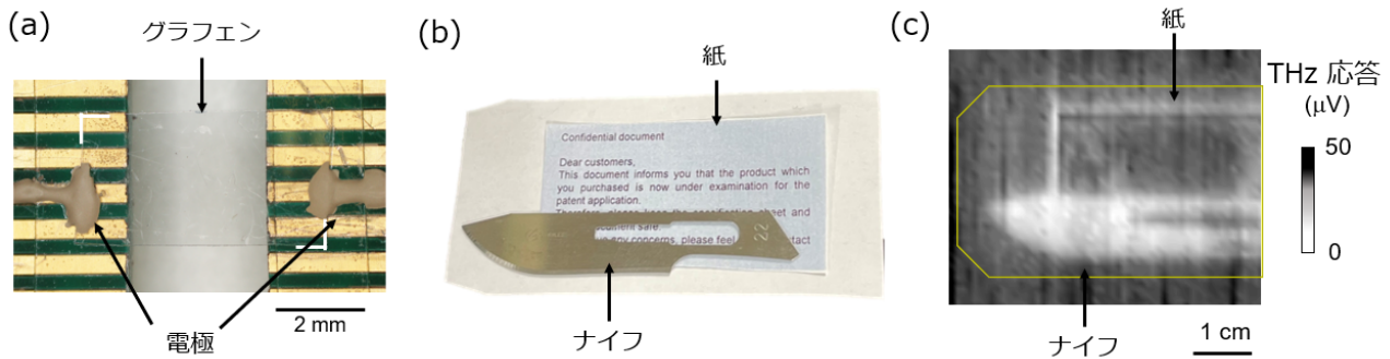
図 7 UV テープ転写したグラフェンのテラヘルツのセンサー応用。(a) プラスチック上の単層グラフェンのセンサー。(b) 封筒に入れる前のナイフと紙片。(c) グラフェンを用いて検出した、封筒の中のナイフと紙片。
